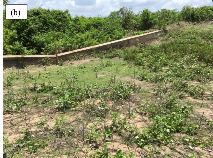
Figura 4. Instalações dos pinos na área de monitoramento: croqui da disposição dos pinos (a) e pinos instalados em campo (b)
