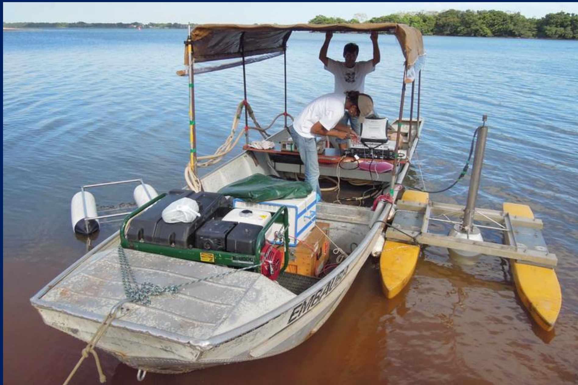
Rio Paraná, São Paulo, Brasil (Sistema de Perfilagem Sísmica Meridata do IPT)
