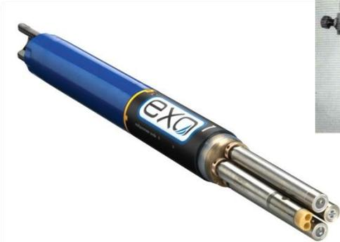
Sondas multiparamétricas: pH, OD, DBO, temperature e turbidez
