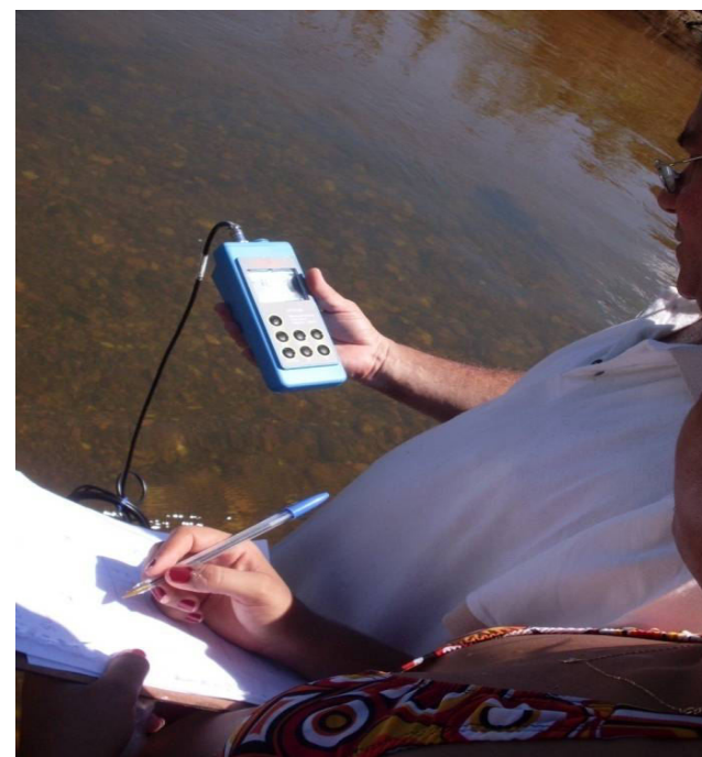
Figura 5 - Medidor de oxigênio dissolvido de modelo 9146 de fabricante Hanna
