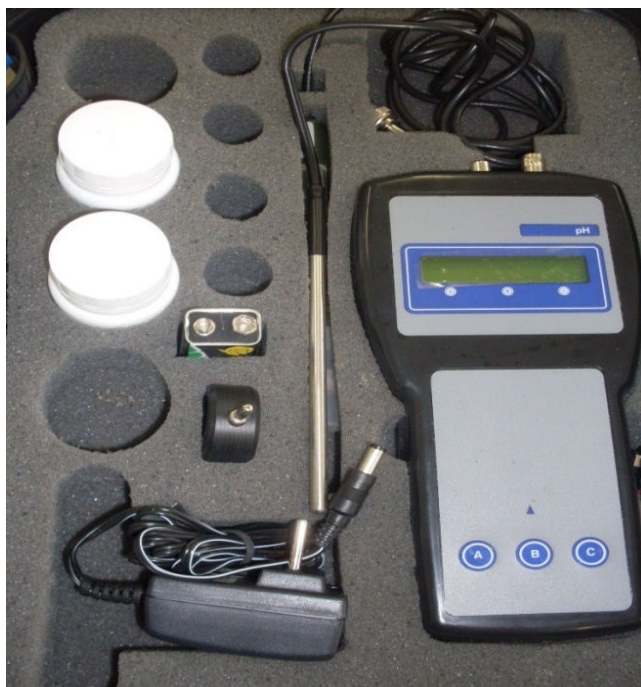
Figura 3 - pHmetro de modelo MPA210p, fabricante MS TECNOPON
