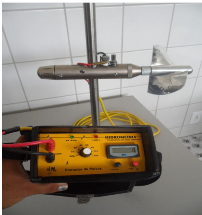
Figura 2 - Molinete fluviométrico do fabricante HIDROMECA - modelo NEWTON
