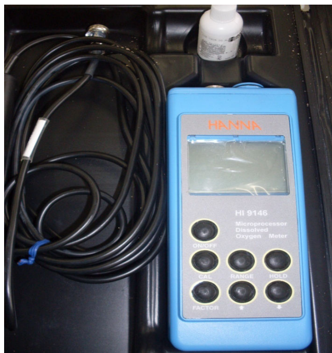
Figura 5 - Medidor de oxigênio dissolvido de modelo 9146 de fabricante Hanna
