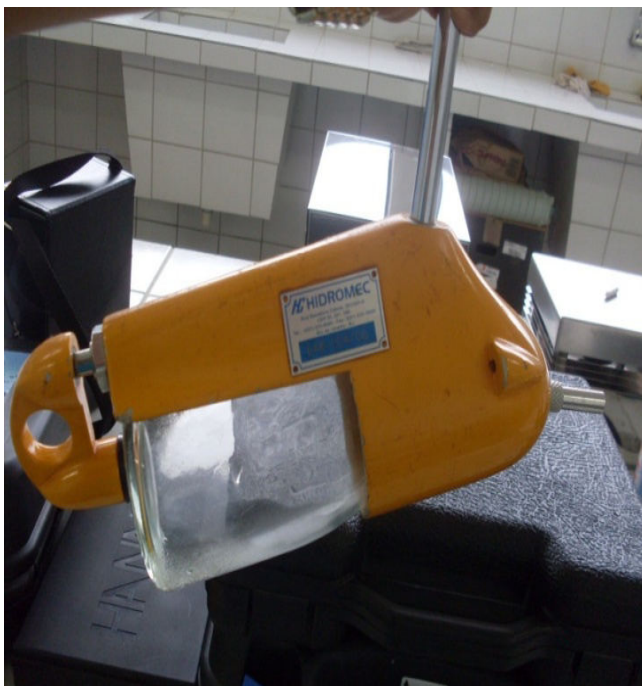
Figura 6 - Coleta de amostras de água a VAU com o amostrador DH-49
