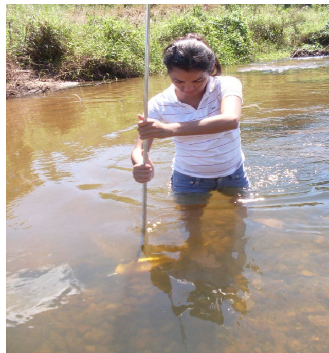
Figura 6 - Coleta de amostras de água a VAU com o amostrador DH-49
