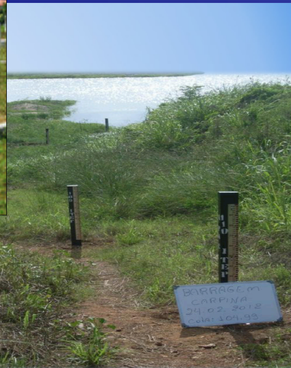
Réguas limnimétricas instaladas - Monitoramento no Reservatório de Carpina.
