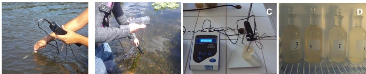
Figura 2 – (A): Medição da Condutividade Elétrica, (B): Medição da OD, (C): Determinação do pH e (D) análise de DBO<sub>5</sub>. Fonte: Autor, 2013.
