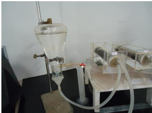
Figura 1. Equipamento usado no ensaio de infiltração horizontal
