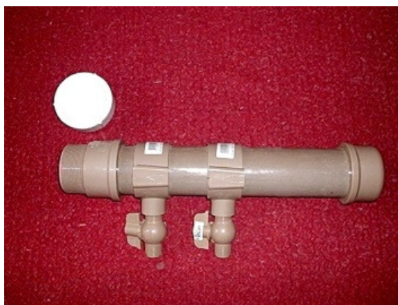
Figura 1 – O clorador é montado com conexões normais conforme mostra a imagem.
